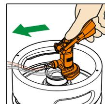
10. Coloque la herramienta del dispensador.
