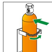
4. Coloque y asegure un nuevo cilindro.
