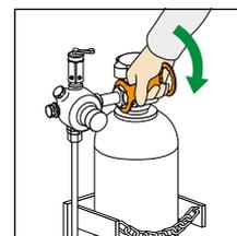
5. Conecte manualmente la válvula reductora.
