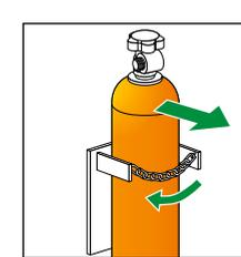
3. Desconecte la cadena de seguridad y saque el cilindro vacío.
