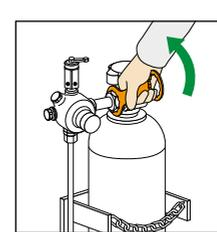
2. Desconecte manualmente la válvula reductora.
