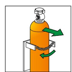
3. Desconecte la cadena de seguridad y saque el cilindro vacío.
