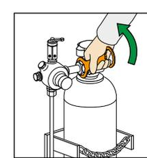
2. Desconecte manualmente la válvula reductora.
