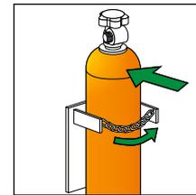
4. Coloque y asegure un nuevo cilindro.
