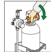
5. Conecte manualmente la válvula reductora.
