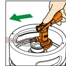
10. Coloque la herramienta del dispensador.
