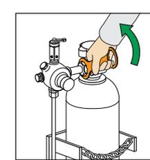
2. Druckreduzierventil mit der Hand abkoppeln.
