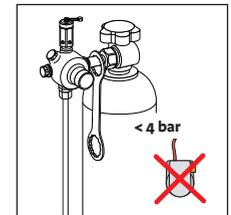
7. Funktioniert nur, wenn die CO<sub>2</sub>-Flasche geöffnet ist und genug CO<sub>2</sub> enthält.
