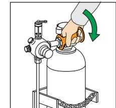
5. Druckreduzierventil mit der Hand anschließen.
