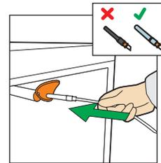
3. Bierschlauch mit hygienischem Verschlussdeckel in den Einlass stecken.
