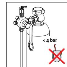
7. Funciona apenas quando o cilindro de CO<sub>2</sub> se encontra aberto e contém CO<sub>2</sub> suficiente
