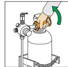
2. Desligue a válvula de redução manualmente.
