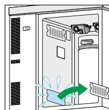
Rimuovere la griglia di ventilazione prima di provvedere alla pulizia del foro di drenaggio
