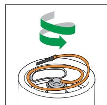
7. Sistemare il tubo di erogazione della birra all'interno del bordo del fusto.
