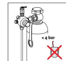
7. Il funzionamento è garantito soltanto se la bombola di CO<sub>2</sub> è aperta e contiene una quantità sufficiente di CO<sub>2</sub>
