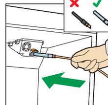
3. Inserire il tubo di erogazione della birra con il tappo igienico e spingerlo fino a quando non compare nel rubinetto di erogazione.
