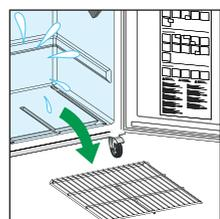
Rimuovere il telaio di supporto del fusto
